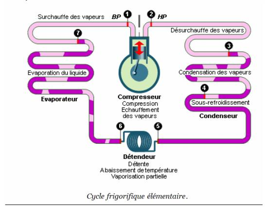
Le nombre de calories et de frigories fournies sont théoriquement égales, les calories supplémentaires générées par l'énergie nécessaires au fonctionnement du compresseur sont ajoutées et évacuées coté condenseur. Le fonctionnement d'une telle machine est donc déséquilibré énergétiquement, elle sera toujours plus performante en production de chaud qu'en production de froid.
